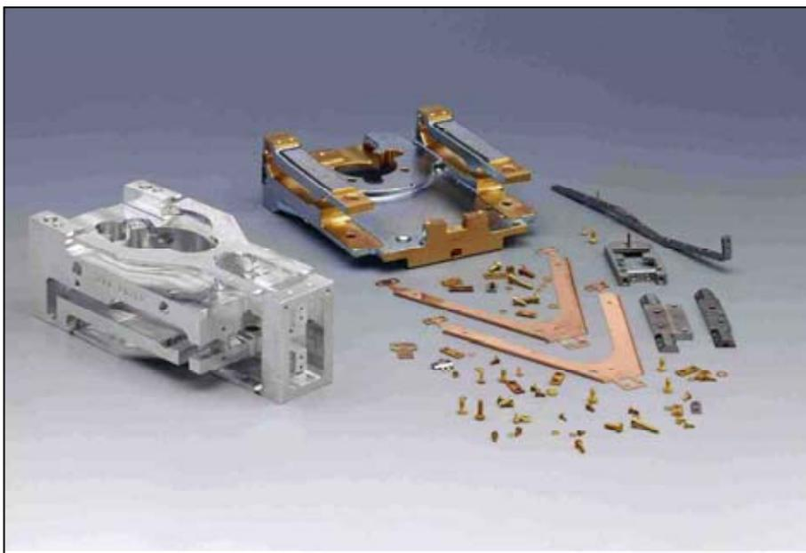
**Abbildung 9:** Vergleich monolithisches (links) und konventionelles Wägesystem
